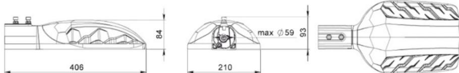
Рисунок 1 Общий вид светильника Street X1 с консольным креплением.
