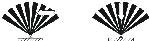
Рисунок 6 – Чувствительность датчика движения
