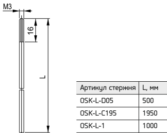
Рисунок 2 – Габаритные и установочные размеры стержня
