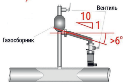
Рисунок 8 – Способы монтажа преобразователя для измерения давления жидкости
