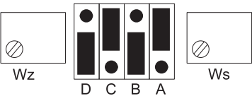
Рисунок 19 – Элементы для настройки диапазона LCD дисплея
