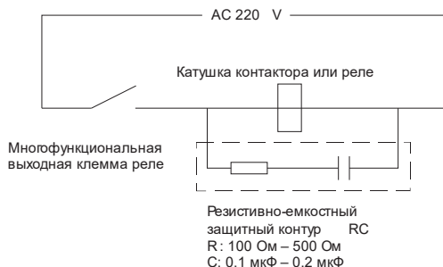
Рисунок 15 – Подключение выходного реле на переменный ток
