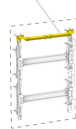
1.4 Крепление кронштейна к основанию** Bracket mount to the base**
