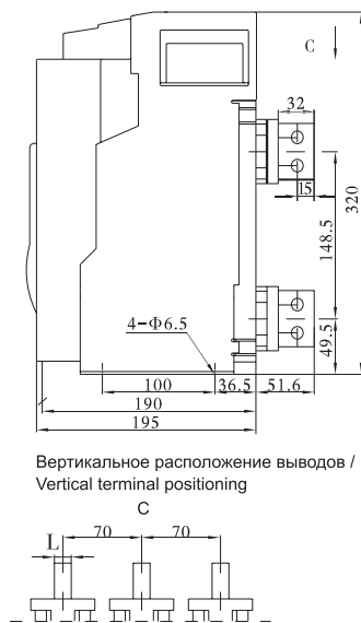
Рисунок / Figure C.4 – Габаритные размеры стационарных трехполюсных выключателей типоразмера A / Overall dimensions of fixed three-pole circuit-breakers of frame size A
