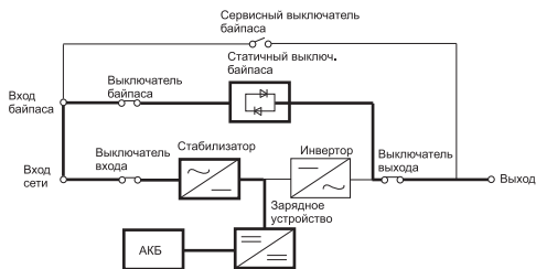
Рисунок 9 – Схема работы ИБП в режиме байпаса
