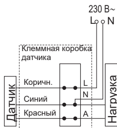
Рисунок 30 – Схема подключения датчиков типов ДД 022 (LDD11-022-2000-001), ДД 023 (LDD10-023-2000-K01)
