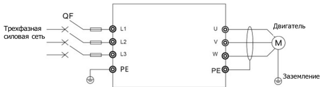
Рисунок 3.19 – Схема подключения для ввода в эксплуатацию
