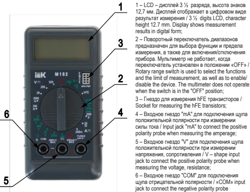
Рисунок 1 – Элементы лицевой панели мультиметра / Figure 1 – Multimeter front panel elements
