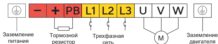
в) трехфазный преобразователь мощностью 11–22 кВт
