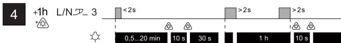
Рисунок 7 – Функциональная диаграмма реле в режиме 4 / Figure 7 – Functional diagram of relay in 4 mode / 7 сурет – 4 режимінде реленің функционалдық диаграммасы
