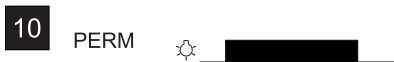
Рисунок 13 – Функциональная диаграмма реле в режиме 10 / Figure 13 – Functional diagram of relay in 10 mode / 13 сурет – 10 режимінде реленің функционалдық диаграммасы
