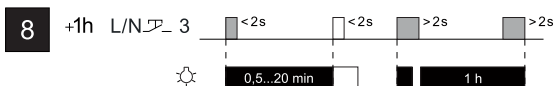
Рисунок 11 – Функциональная диаграмма реле в режиме 8 / Figure 11 – Functional diagram of relay in 8 mode / 11 сурет – 8 режимінде реленің функционалдық диаграммасы
