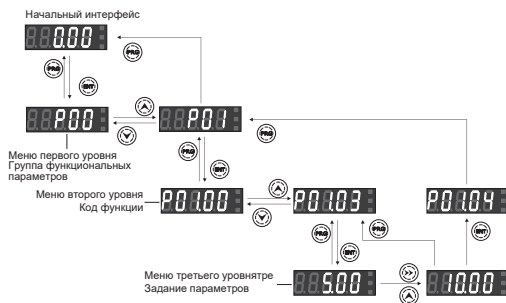
Рисунок 3.13 – Алгоритм изменения параметров функций
