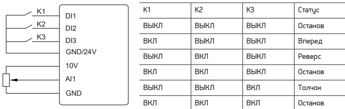
Рисунок 3.18 – Схема управления преобразователя с клемм
