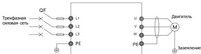
Рисунок 3.17 – Схема подключения для ввода в эксплуатацию
