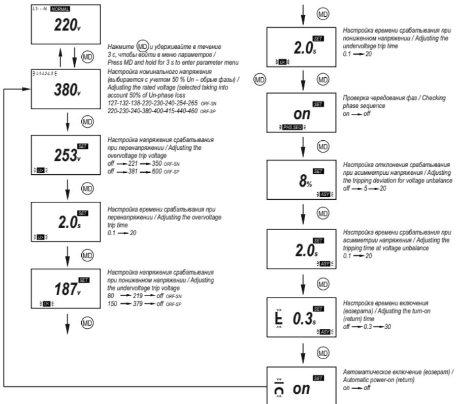
в) / с) Настройка параметров работы реле / Setting the operating parameters of the relay / Релепіні жұмыс параметрлерін баптау
