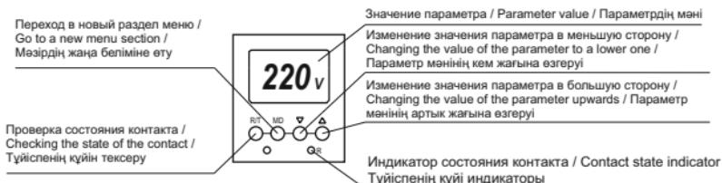
Рисунок 9 – Назначение органов управления реле ORF-S / Figure 9 – The assignment of the relay controls ORF-S / Сурет 9 – ORF-S релесінің басқару органдарының мақсаты
