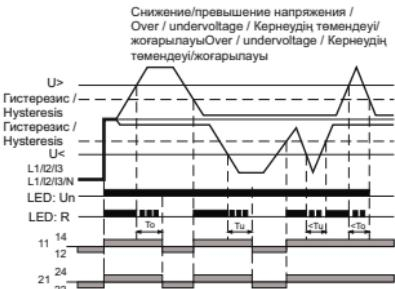
То – задержка срабатывания при достижении предела перенапряжения /
