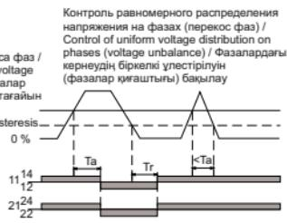
Рисунок 5 – Функциональные диаграммы реле ORF-10, ORF-S / Figure 5 – Function diagrams of ORF-10, ORF-S relay / Сүрет 5 – ORF-10, ORF-S релесінің функционалдық диаграммалары
