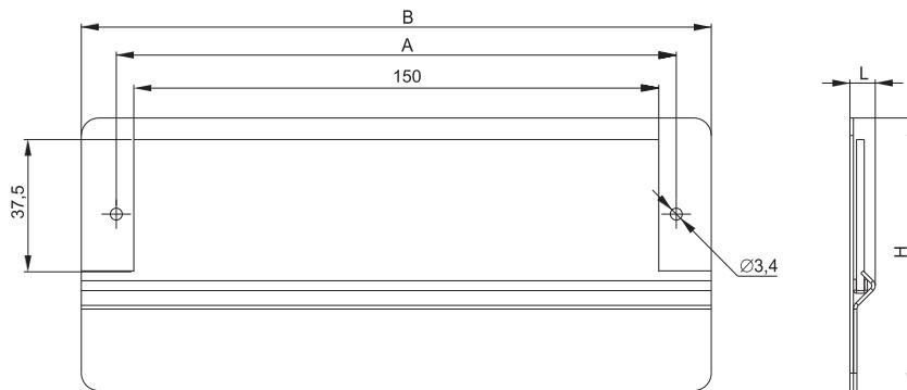
Габаритные и установочные размеры ввода щеточного / Overall and mounting dimensions of brush strip / Щеткалық кірменің габариттік және орнату өлшемдері (BE35-01UM, BE05-01UM, BE35-02UM, BE05-02UM)
