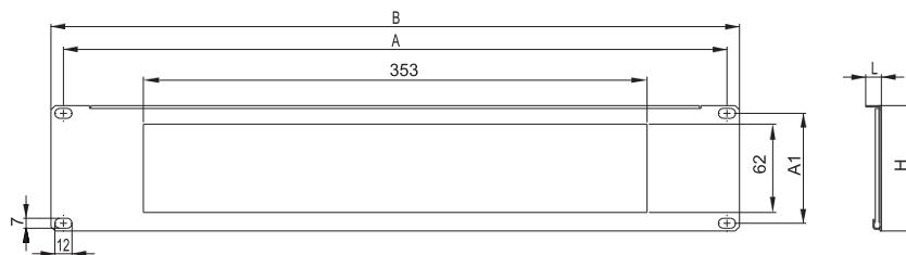
Габаритные и установочные размеры щеточного кабельного ввода / Overall and mounting dimensions of brush strip / Щеткалық кабель кірмесінің габариттік және орнату өлшемдері (BE05-390-115M, BE35-390-115M)
