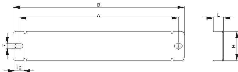
Габаритные и установочные размеры щеточного кабельного ввода / Overall and mounting dimensions of brush strip / Щеткалық кабель кірмесінің габариттік және орнату өлшемдері (BE35-180-55M-LWS, BE05-180-55M-LWS)
