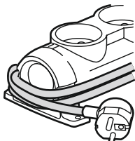
Рисунок 2 – Укладка кабеля при хранении / Figure 2 – Cable laying during storage / Сурет 2 – Сақтаған кезде кабелді төсеу / Figura 2 – Plasarea cablurilor în timpul depozitării
