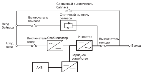
Рисунок 9 – Схема работы ИБП в режиме АКБ
