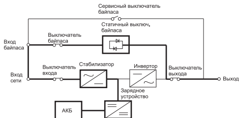
Рисунок 10 – Схема работы ИБП в режиме байпаса
