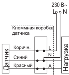
Рисунок 16 – Схема подключения датчиков типов: ДД 008, ДД 009, ДД 010, ДД 012, ДД 018В
