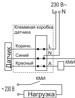
Рисунок 21 – Схема подключения датчика с контактором КМИ
