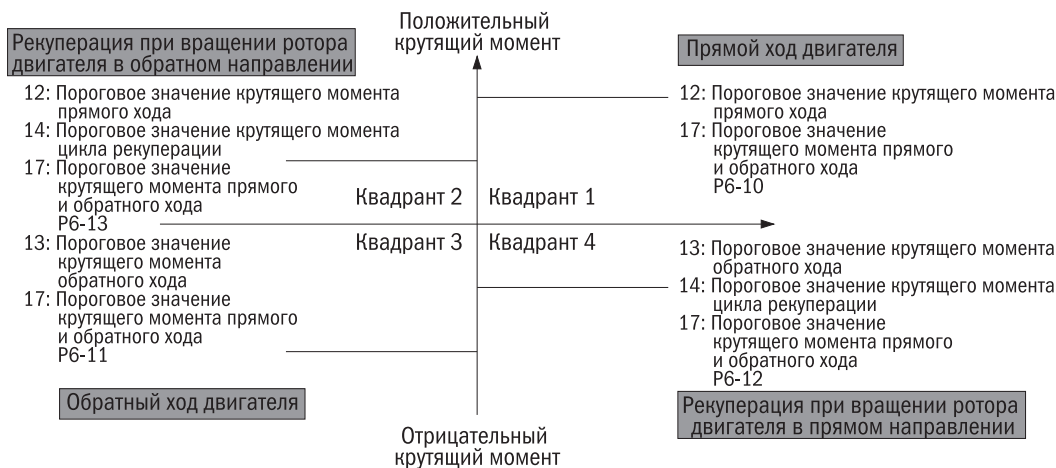
Рисунок 6.67. Настройка порогового значения крутящего момента через аналоговый ввод
