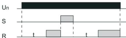
Рисунок 4 – Функциональная диаграмма реле задержки включения / Figure 4 – Functional diagram of on-delay relay /
