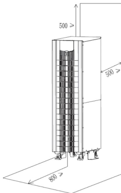
Рисунок 4 – Пример установки ИБП
