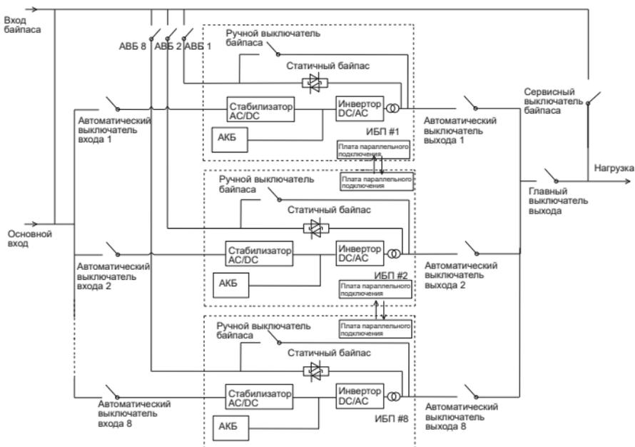
Рисунок 32 – Схема параллельного подключения ИБП с двойным входом
