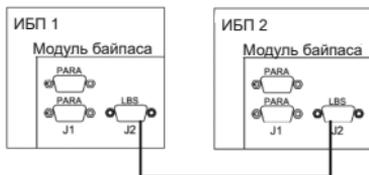
Рисунок 35 – Подключение LBS портов
