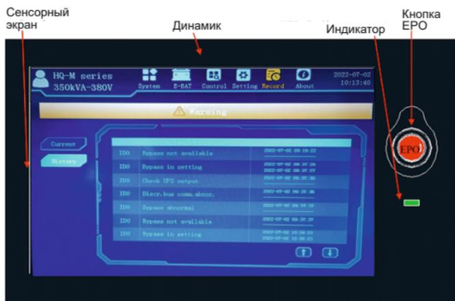
Рисунок 24 – Панель управления ИБП 125–200 кВА
