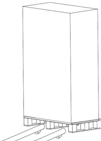
Рисунок 5 – Транспортирование ИБП
