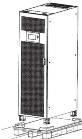
Рисунок 6 – Перемещение ИБП с поддона
