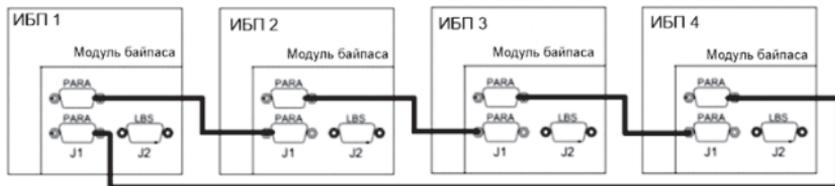
Рисунок 34 – Схема подключения соединительного кабеля плат параллельного подключения
