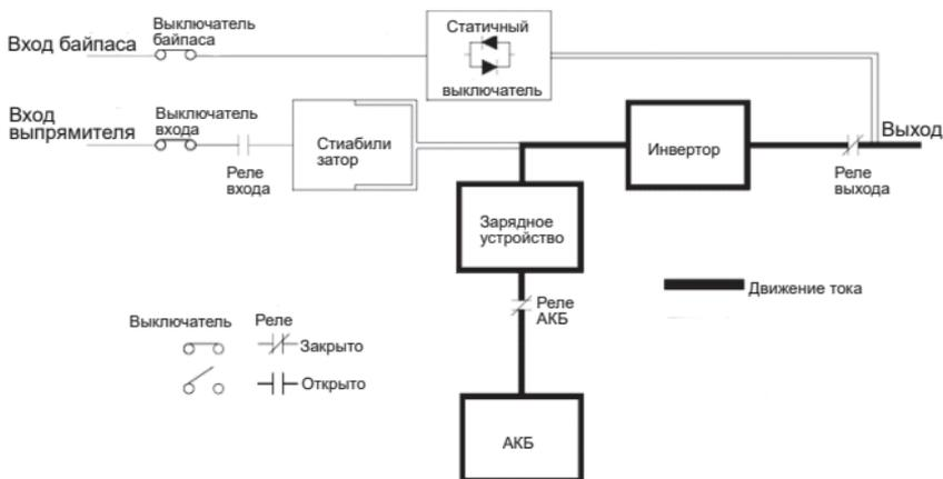
Рисунок 15 – Схема работы ИБП в режиме АКБ
