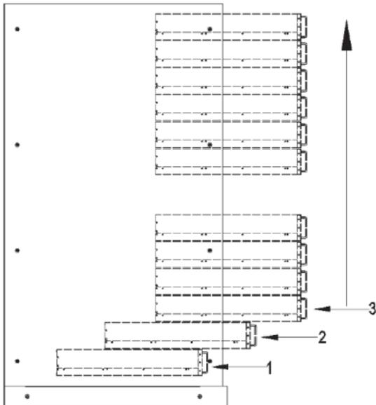
Рисунок 11 – Установка модулей в корпус ИБП серии ELECTRA OM
