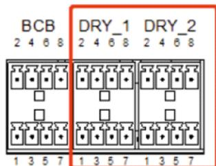
Рисунок 20 – Сухие контакты аварийных оповещений
