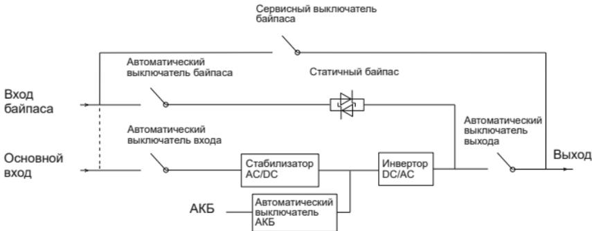
Рисунок 12 – Структура ИБП
