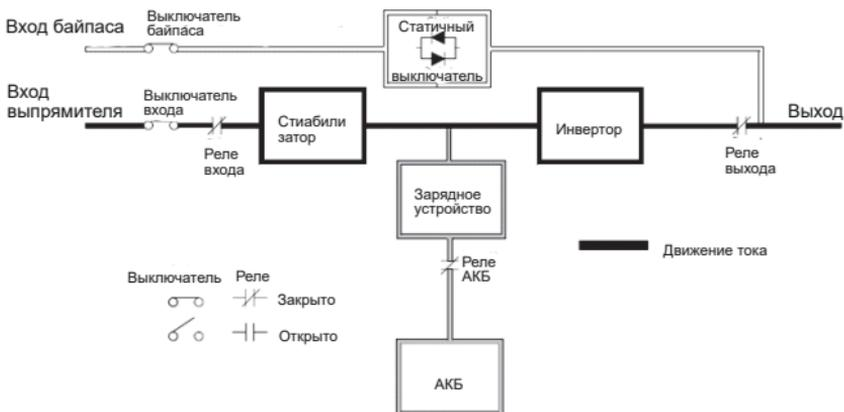
Рисунок 13 – Схема работы ИБП в стандартном режиме
