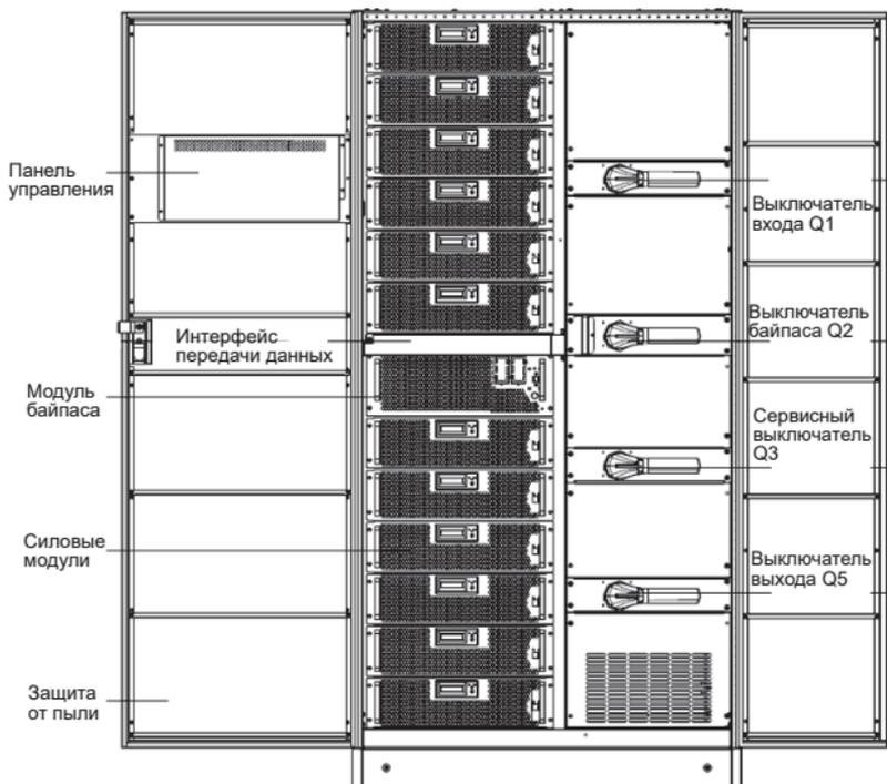
Рисунок 8 – Компоненты ИБП на 12 силовых модулей серии ELECTRA OM
