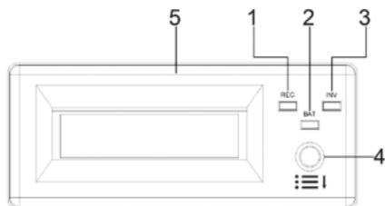
Рисунок 24 – Панель управления силового модуля ИБП 300–500 кВА
