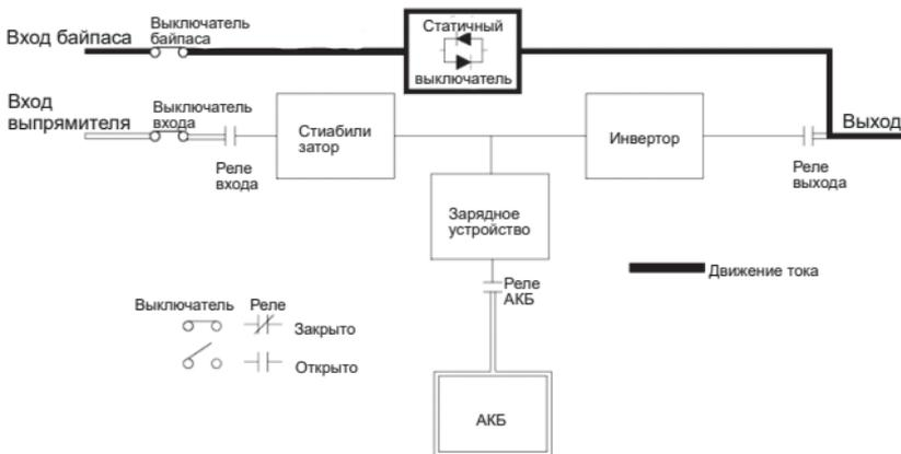
Рисунок 14 – Схема работы ИБП в режиме байпаса
