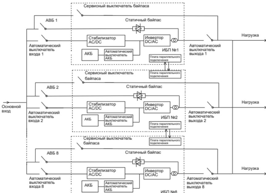
Рисунок 33 – Схема параллельного подключения ИБП с одним входом
