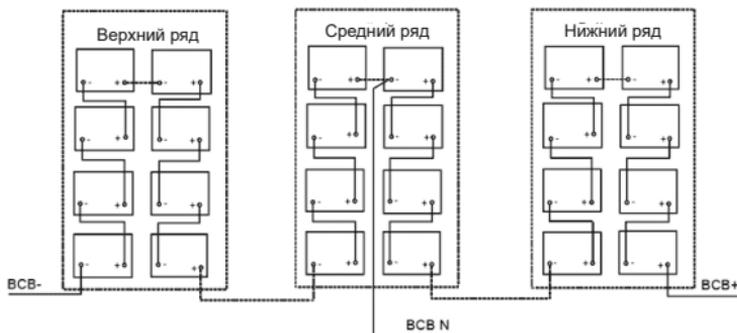
Рисунок 31 – Схема подключения АКБ
