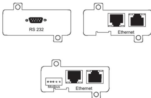
Рисунок 22 – Карты расширения доступа
