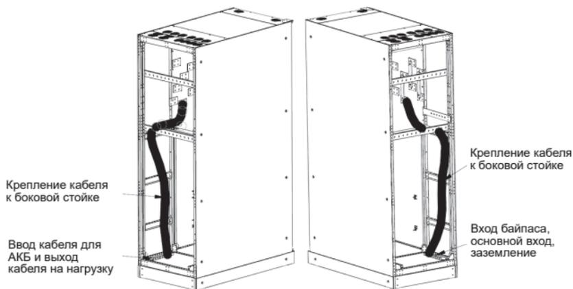
Рисунок 16 – Прокладка кабеля ИБП серии ELECTRA OM на 7 модулей
