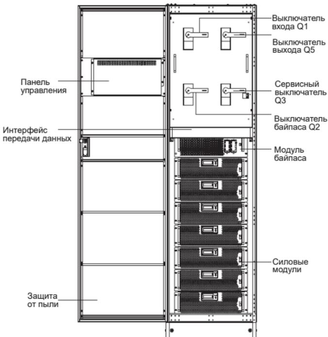
Рисунок 7 – Компоненты ИБП на 7 силовых модулей серии ELECTRA OM
