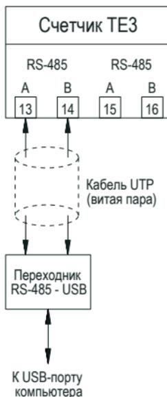
Рисунок 5 – Подключение к счетчику по RS-485
