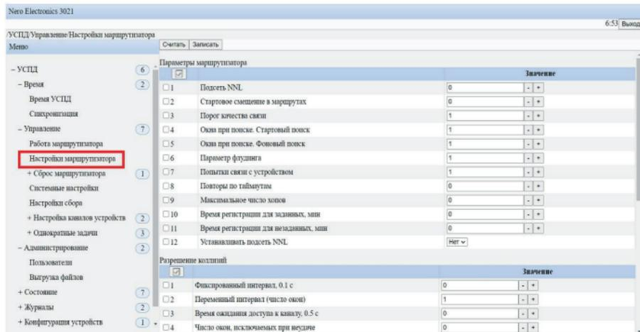
Рисунок А.5 – Настройки маршрутизатора УСПД
