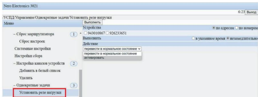
Рисунок А.12 – Активация реле счетчика
