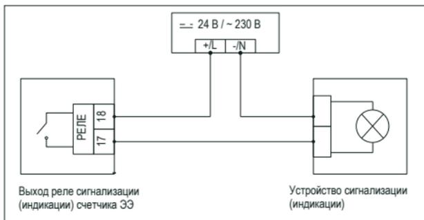
Рисунок 12 – Схема подключения выходов реле сигнализации
