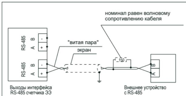
Рисунок 9 – Схема подключения счетчика к цифровой сети RS-485
