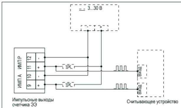
Рисунок 11 – Схема подключения импульсных выходов счетчика
