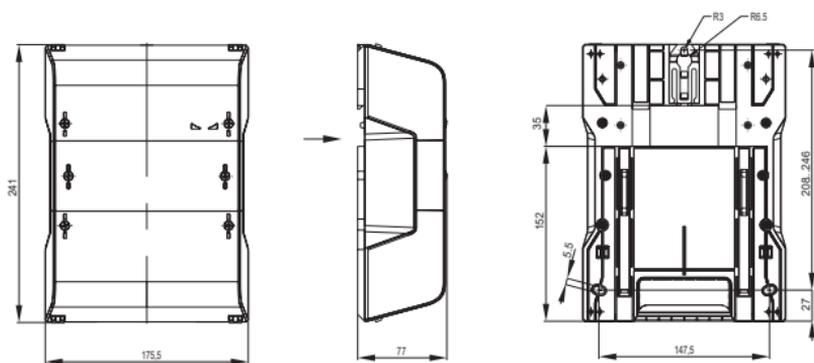
Рисунок 6 – Габаритные и установочные размеры счетчика
