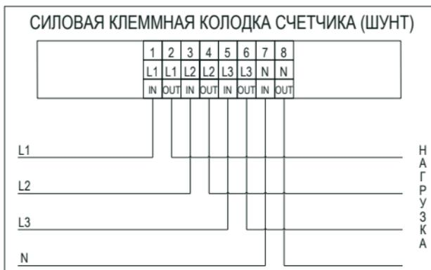
Рисунок 8 – Схема подключения счетчика к сети электроснабжения напрямую
