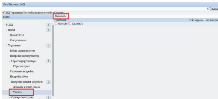
Рисунок А.11 – Удаление счетчиков из списка УСПД
