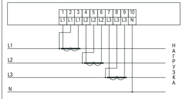
Рисунок 7 – Схема подключения счетчика к сети электроснабжения через трансформаторы тока
