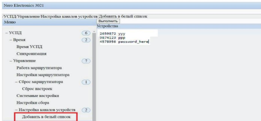
Рисунок А.10 – Добавление счетчиков в список УСПД
