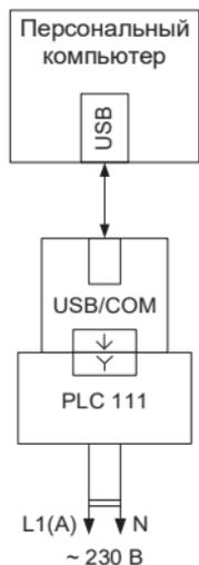
Рисунок 4 – Подключение к счетчику по PLC
