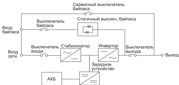
Рисунок 8 – Схема работы ИБП в режиме АКБ
