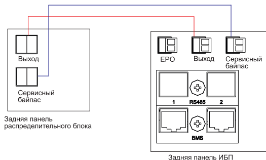
Рисунок 26 – Схема подключения контактов к распределительному блоку
