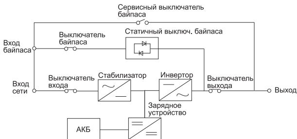
Рисунок 9 – Схема работы ИБП в режиме байпаса
