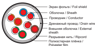
Рисунок 4 – Конструкция кабеля типа F/UTP (количество жил 4×2) / Figure 4 – Cable design of F/UTP type (number of cores 4×2)
