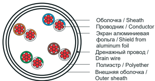
Рисунок 2 - Конструкция патч-корда типа F/UTP / Figure 2 - Design of F/UTP patch cord
