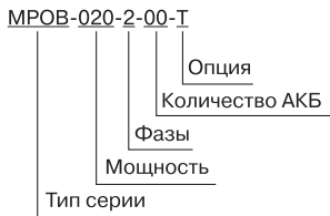
Рисунок 1 – Структура обозначения ИБП
