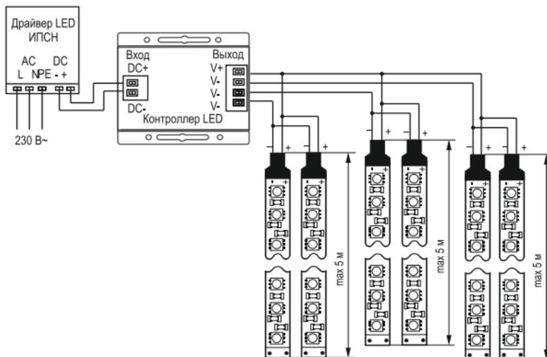
Рисунок 6 – Схема параллельного подключения к контроллеру одноцветных лент разного цвета к отдельному каналу контроллера с общим анодом
