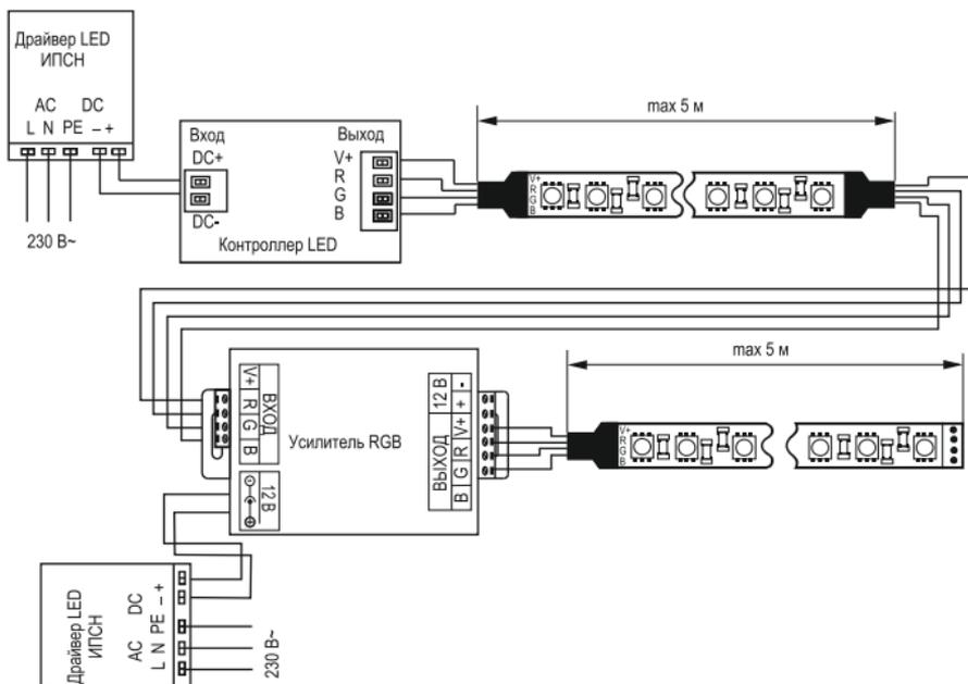
Рисунок 10 – Схема последовательного подключения RGB усилителя
