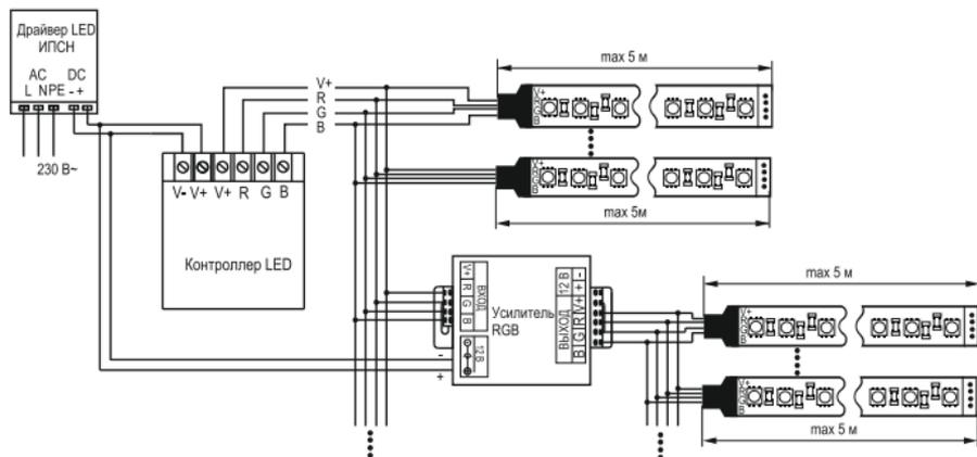
Рисунок 11 – Схема параллельного подключения RGB усилителя
