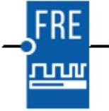
Счетчик выполняет подсчет количества импульсов на входе FRE за время заданного временного интервала и последующее сравнение полученного значения с заданными пороговыми значениями включения и выключения.
