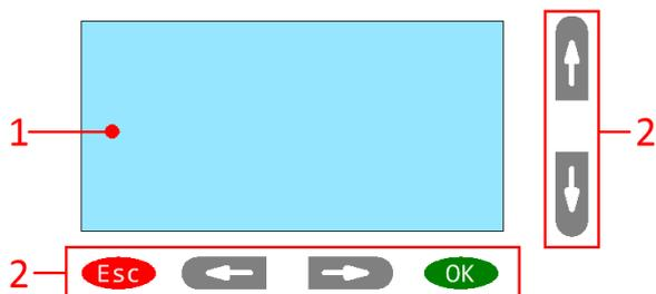
Рисунок 1.22 - Дисплей и клавиатура моделей [PLR-430-CPU-12U06R-1DC-00](#), [PLR-430-CPU-12D06R-1AC-00](#)
